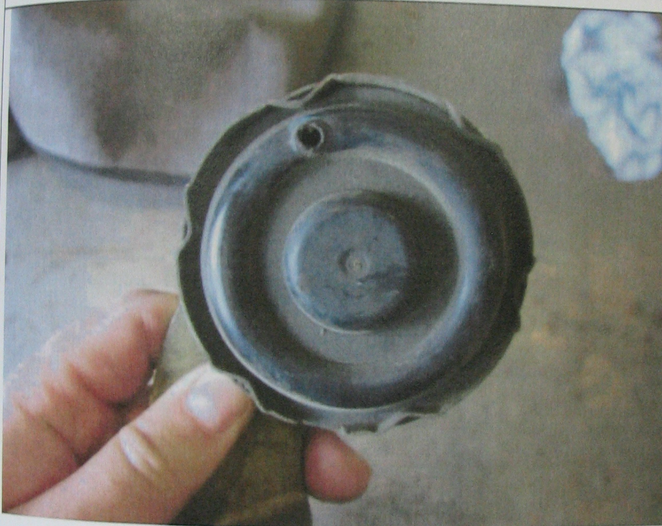
Кадр 11. Повреждения крышки муфты включения переднего привода.
