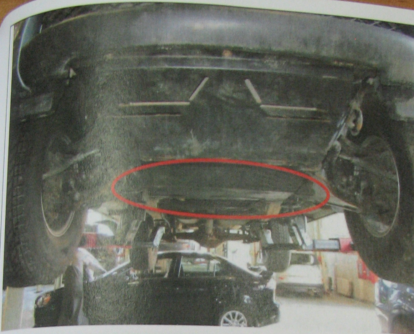
Кадр 10. Повреждения защиты деталей моторного отсека.
