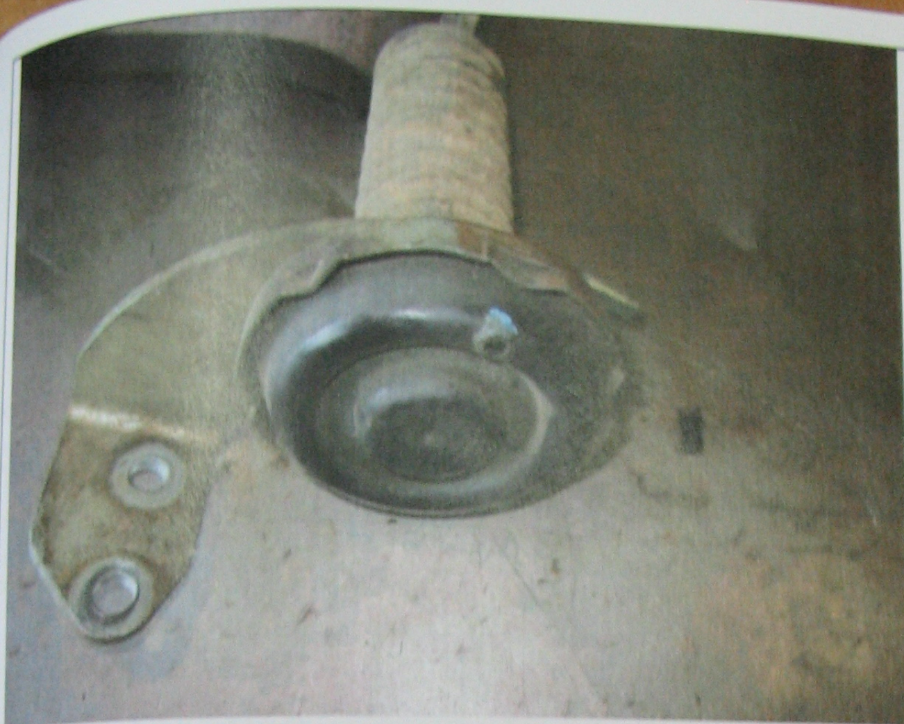
Кадр 13. Повреждения крышки муфты включения переднего привода.
