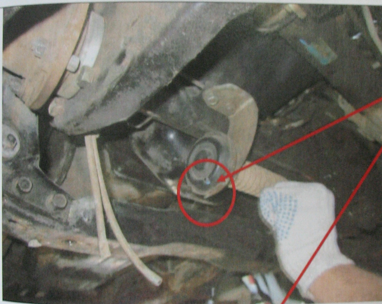
Кадр 14. Повреждения крышки муфты включения переднего привода.
