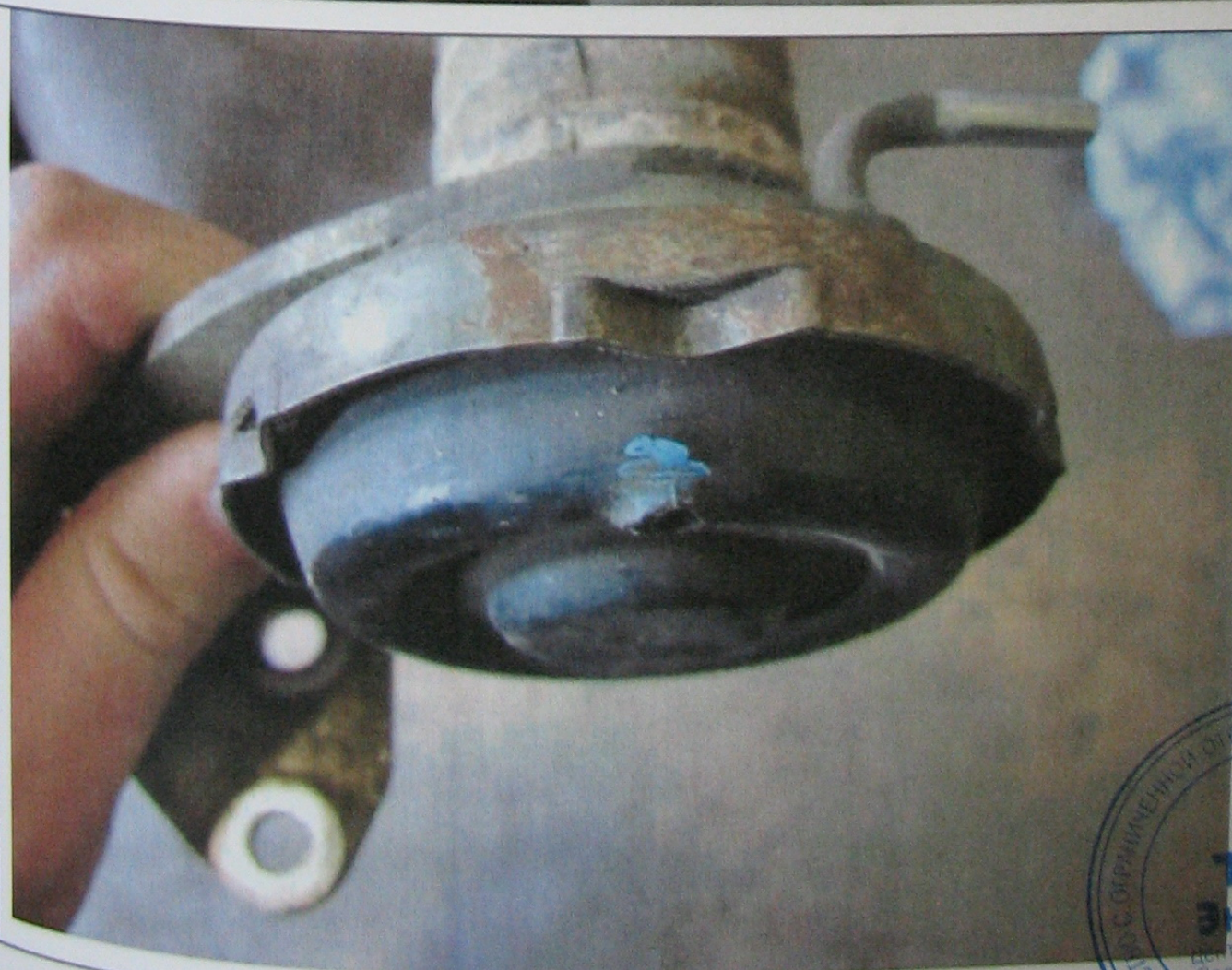
Кадр 12. Повреждения крышки муфты включения переднего привода.
