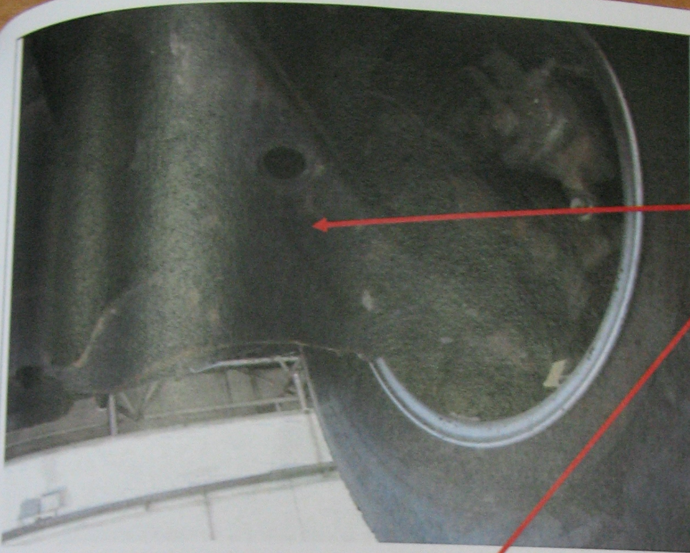
Кадр 7. Следы внешнего воздействия на рычаги передней подвески.
